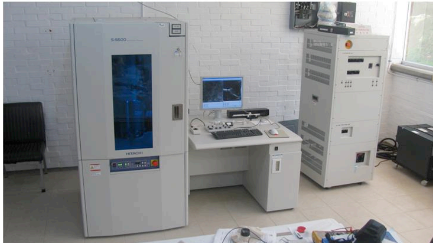
Fig. 27. Vista interior del Laboratorio de Caracterización de Fotocatalizadores Nanoestructurados. Microscopio Electrónico de Barrido Hitachi FE SEM S-5500.
