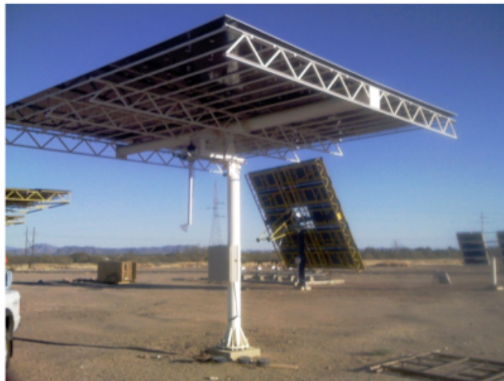
Figura 7. Helióstato de 36 m 2 UNISON-TX-H36.
