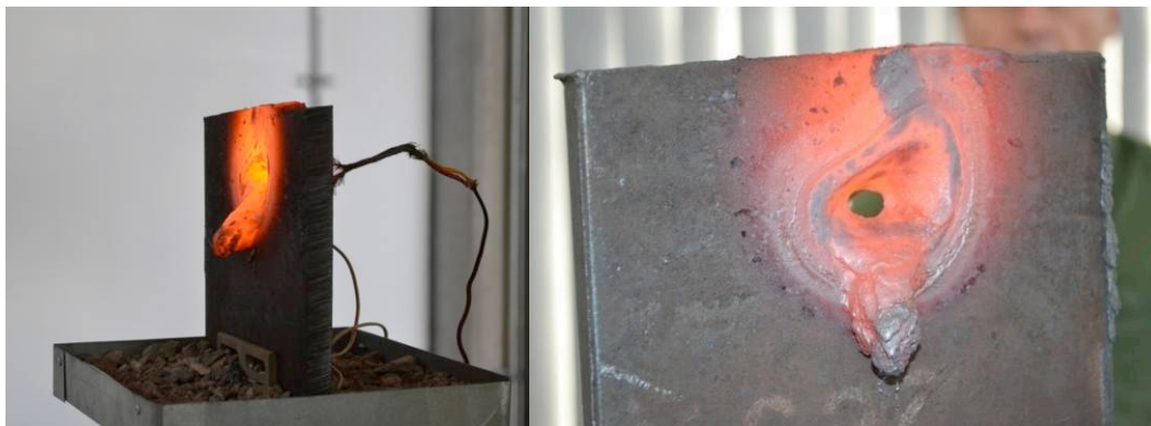
Fig. 21 Fotografías después de la perforación de la placa de 19 mm de espesor.
