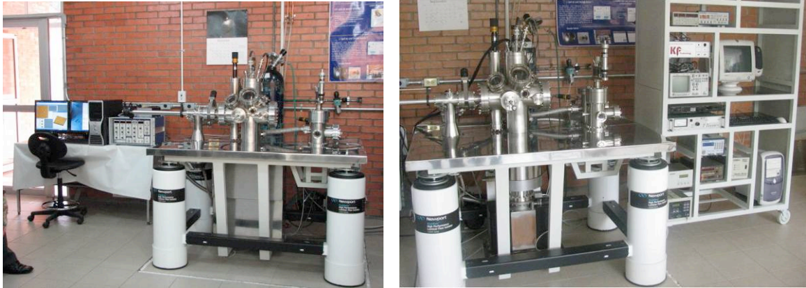
Fig. 29 (Izq.) Microscopio Electrónico de Tunelaje (STM), (Der.) Dispositivo Kelvin y Celda Termoiónica.
