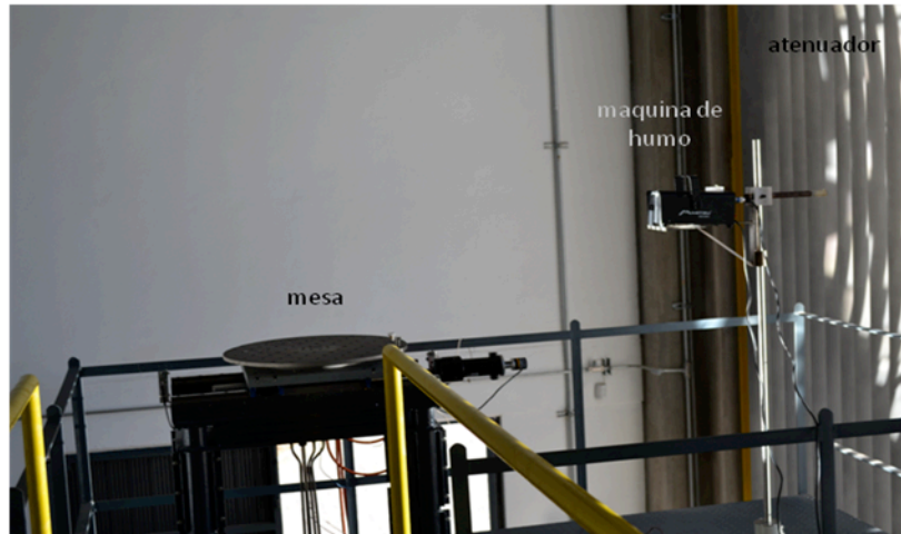
Fig. 17 Arreglo experimental para determinar la zona focal y la forma de los rayos incidentes.
