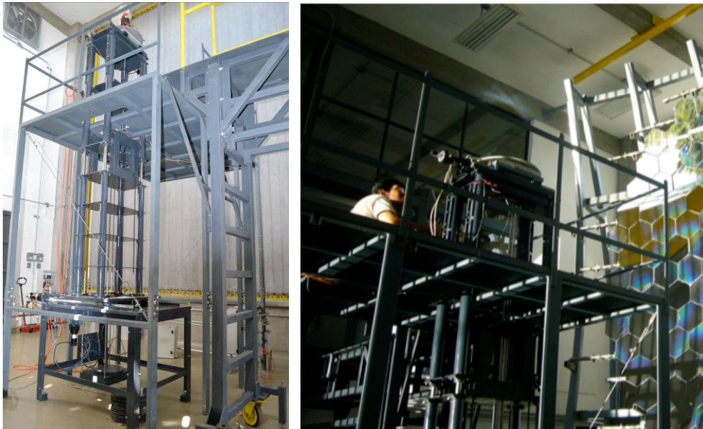
Fig. 9. Fotografías de la mesa con movimiento tridimensional y capacidad de carga de 250 Kg. También se aprecia la plataforma de experimentación del Horno.
