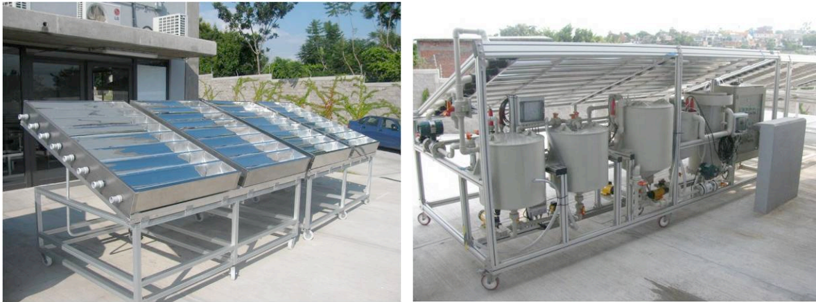
Fig. 23. Reactor fotocatalítico para Fotocatálisis Heterogénea con \text{TiO}_2 diseñado y fabricado en el CIE-UNAM.
