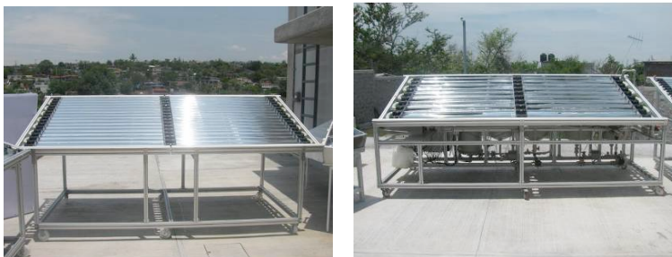
Fig. 22. Captadores solares para Fotocatálisis Homogénea por medio de procesos foto-Fenton. (Izq.) Comprados, (Der.) Fabricados en el CIE.
