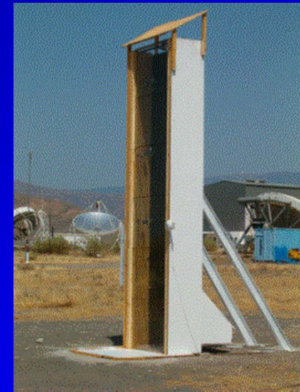
Prototipo de chimenea solar
